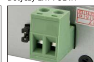
Dodatkowe wejście zasilania: 44÷57VDC (złącze śrubowe)
