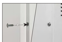
Zamykanie – skręcanie od czola – 1 szt.
