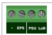
Wyjścia techniczne typu OC
