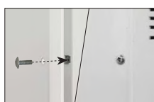
Zamykanie - skręcanie od czoła - 2 szt.
