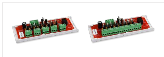
Moduły sekwencyjne EN54C-LS4, EN54C-LS8
