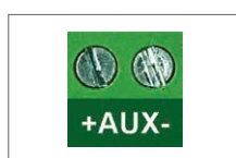
Zaciski wyjścia zasilania DC
