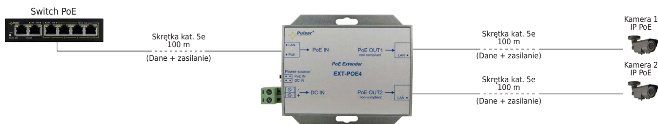
Wydłużenie zasięgu kamery IP PoE o kolejne 100m
