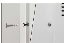
Zamykanie – skręcanie od czoła – 2 szt.
