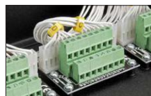
Złącza niskonapięciowe 3 (6) płytki - 8x2 żyły
