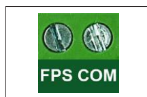
Wyjście techniczne typu OC FPS – awaria bezpiecznika
