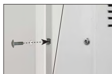
Zamykanie – skręcanie od czoła – 2 szt.
