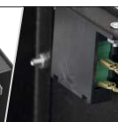
Tamper otwarcia obudowy
