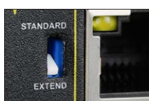
Przełącznik (Tryb Long Range) *
