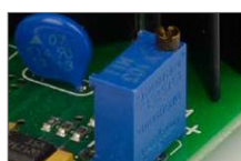
Potencjometr, regulacja napięcia
