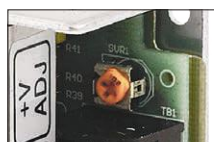
Potencjometr regulacji napięcia wyjściowego
