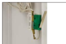
Tamper otwarcia obudowy - 1 szt.
