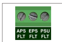
Wyjścia techniczne typu OC
