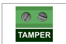
Wyjście sygnalizujące otwarcie obudowy zasilacza
