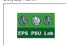
Wyjścia techniczne typu OC: EPS, PSU, LoB
