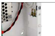
Tamper otwarcia obudowy – 1 szt.
