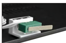
Tamper otwarcia obudowy x 2
