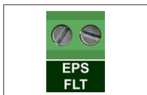
Wyjście przekaźnikowe EPS sygnalizacji zaniku sieci 230VAC
