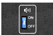
Sygnalizacja akustyczna awarii - BUZZER - możliwość załączenia / wyłączenia
